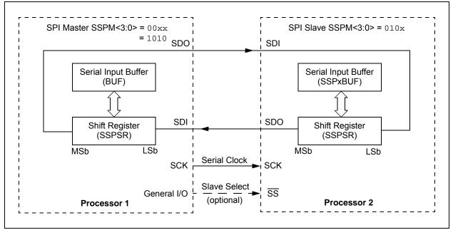
FIGURE 24-5: SPI MASTER/SLAVE CONNECTION
